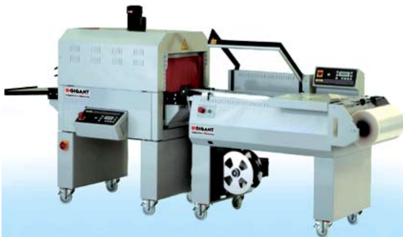
Die Gigant Winkelschweißmaschine FP 560 & Tunnel 450 – halbautomatische und programmierbare Maschine zum produktiven Verpacken
