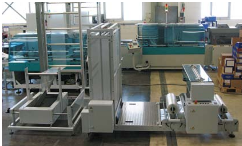
Wechselvorrichtung: Folienrollen-Wechselautomat mit Folien-speicher- und Faltvorrichtung.
