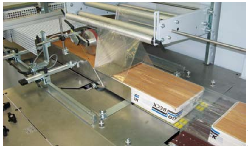
Einlaufbereich: Folienzuführung und Formschulter, für abfallfreies Verpacken. (Fotos: gigant)
