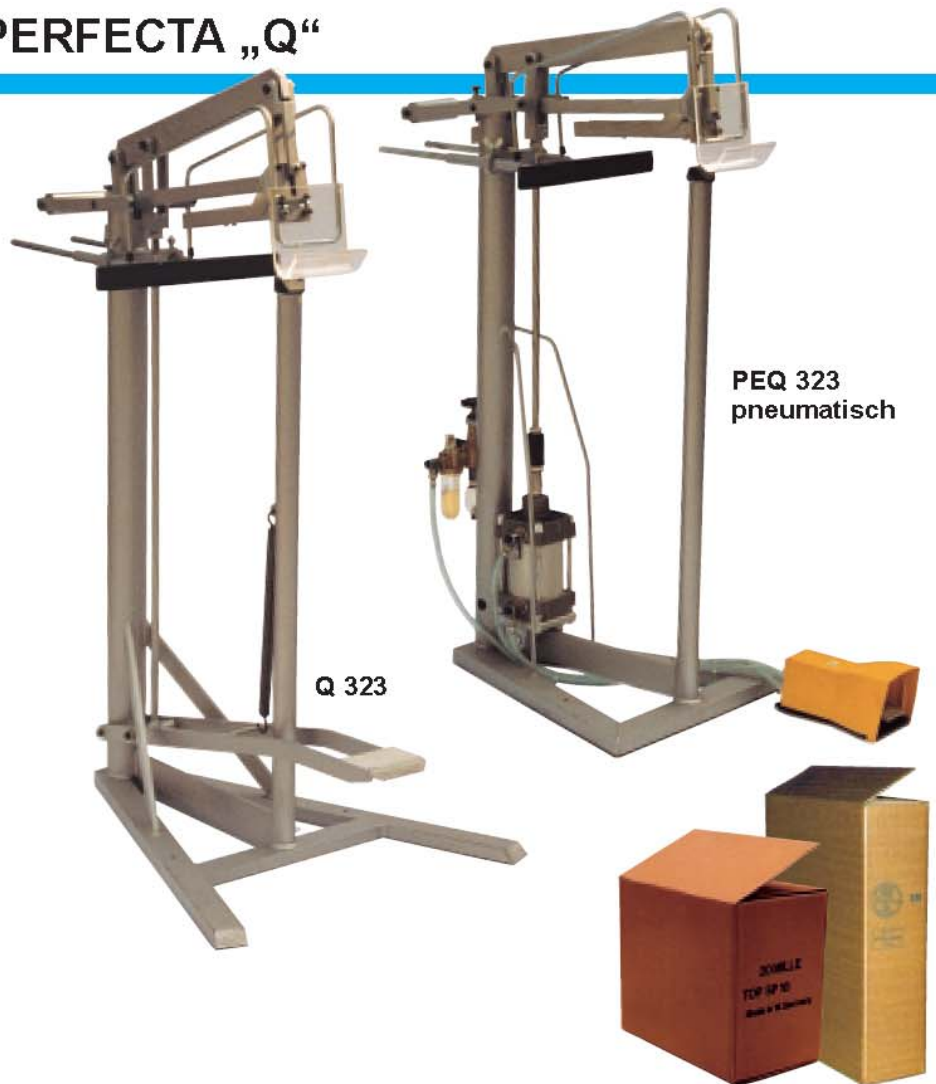
PEQ 323 Quer angebrachter Heftkopf und ein schnell verstellbarer Anschlag ermöglichen
