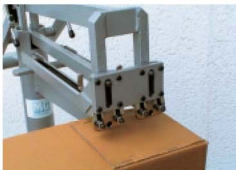
ST Q 270 D Doppelkopf. Heftabstand 70 mm. Zwei Heftungen gleichzeitig.
