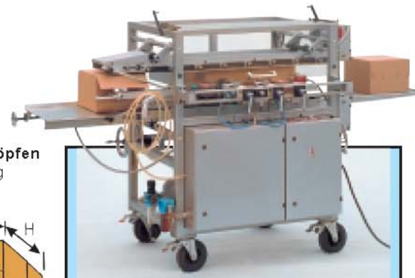
Faltschachtelboden-Heftautomat KBH 75 mit 2 Rollenklammern-Heftköpfen mit jeweils 5000 Heftklammern/Rolle.
