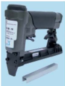
TACKER R1B pneumatisch für Heftklammern DUO 50/8 - 14 mm Gewicht: 780 g, Luftdruck 4 - 6 bar.
