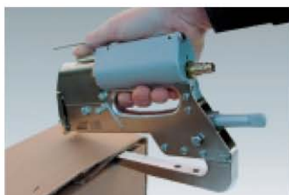
Boden- und Deckelteil miteinander verheften.
