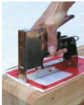
RAPID 34 mechanischer Tacker für Klammern 11/6 - 14 mm. Anheften von Pappe, Folie, Isoliermaterial, Teppiche usw. auf Holz. Verchromt, 870 g, Schlagstärke einstellbar.
